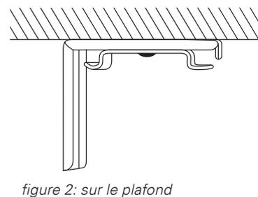
**1.** Fixer les 2 supports extérieurs à un vingtaine centimètres du bout du boîtier. Faites attention que les supports ne sont pas fixer sur les places où il y a des parties dans le boîtier.
